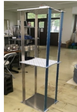
振動特性を調査するための縮小モデル (左：二階建て建物，右：貯水タンク)
